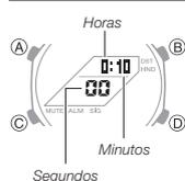
O tempo inicial do timer pode ser definido em incrementos de 1 segundo até um máximo de 24 horas. Um alarme soa quando a contagem regressiva atinge zero.
